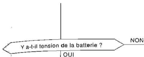
— Réparer le câble coupé ou en court-circuit entre le relais principal PGM-FI et le fusible N° 31 du SIGNAL du DEMARREUR (7,5 A)
