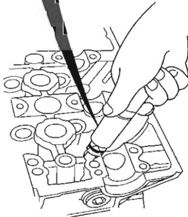
4. Reposer le ressort de soupape et la retenue de soupape, puis reposer le compresseur du ressort de soupape. Comprimer le ressort et reposer les retenues de soupape.
