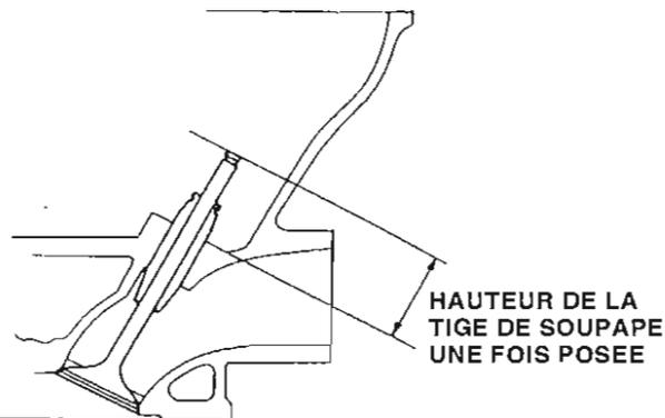
8. Si la hauteur de la tige de soupape une fois posée est supérieure à la limite de service, remplacer la soupape et contrôler à nouveau. Si elle est toujours en dehors de la limite de service, remplacer la culasse, le siège de soupape est trop enfoncé dans la culasse.
